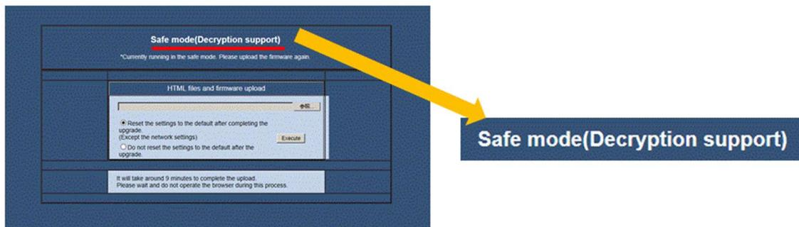
セキュリティ対応画面でのセーフモード時は、いずれのバージョンでもバージョンアップ、ダウンが可能です。(中間バージョンへのバージョンアップは不要です。)
