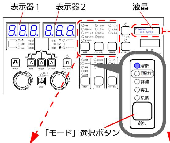
現在の材質・ワイヤ径・溶接法（または初期設定）のLEDが点灯
