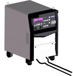
母材側ケーブルおよびトーチ側ケーブルを図のように巻き重ねて使用しないでください。巻き重ねた場合、ケーブルインピーダンスによりアークが不安定になります。
