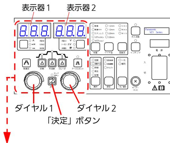
制御法表示器のうち、点灯しているLEDに対応する選択ボタンを押す。
