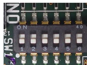
本スイッチは、本製品の機能を拡張するためのものです。出荷設定（すべて OFF 側）で使用しますので、機能拡張とオプション接続時以外は変更しないでください。
