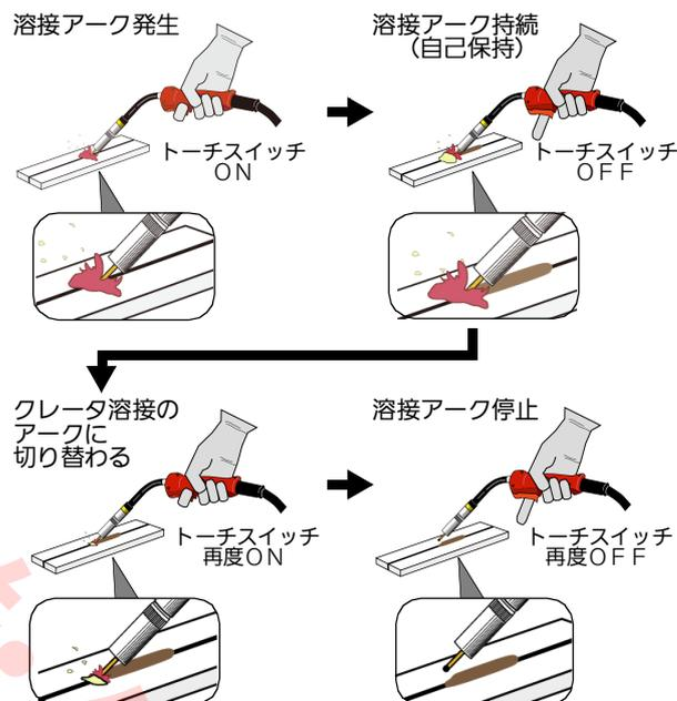
自己保持：トーチスイッチ操作で、スイッチ操作を自己保持させます。(ただし、溶接中に0.5秒以上アークが切れ続きますと、自己保持は解除されます。)
