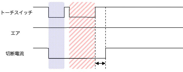
操作限定が解除され、アフターフローが継続している状態で切斷を開始する場合、1秒のプリフロー期間があります。
