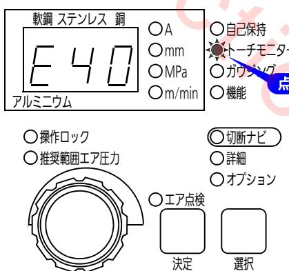
(4) 電極・チップを新しいものに交換し、(1)のようにリセット処理を行ってください。
