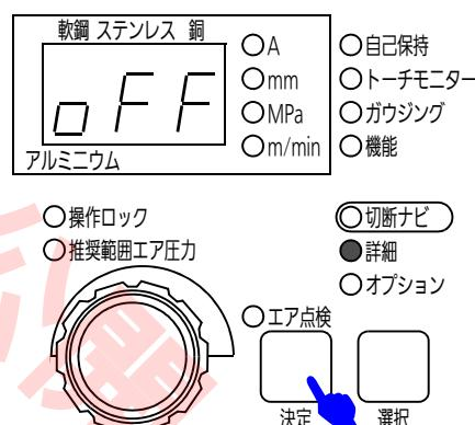
(2) 詳細メニュー「トーチモニターリセット(P04)」または「トーチモニタータイム設定(P05)」に入り、ダイヤルを回して設定したい回数、または時間に合わせ決定ボタンを押せば設定値が変更されます。
