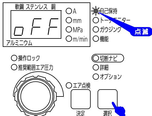
(2) ダイヤルを回して、パラメーターの設定値を変更し、決定ボタンを押して確定します。
