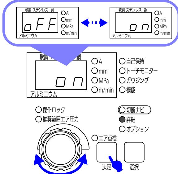
(4) 選択ボタンを押して、詳細 LED が消灯の状態になれば待機状態に移行します。
