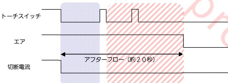
操作定期間にTouch Switchを押すと、操作限定が解除され、通常の操作が可能になります。ただし、アフターフロー(約20秒)は継続します。
