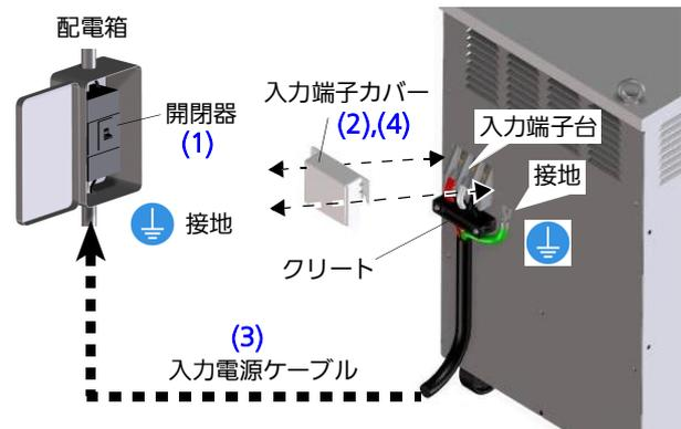
本製品 1 台に対し、1 個の開閉器（配電箱内）を設置してください。
