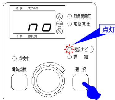
(2) ダイヤルを回して、「yES」を表示させ選択ボタンを押します。
