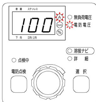
(2) ダイアルを回し、溶接電流を変更します。
