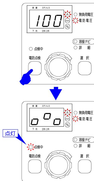
(2) 電防電圧印加回路のリレーの融着チェックを行います。(0.5 秒)
