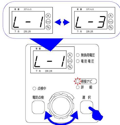
(4) デジタル表示器が「---」もしくは「out」を表示しているときに、選択ボタンを押すと詳細メニューを終了し、電防回路点検を行い、溶接待機状態へ移行します。
