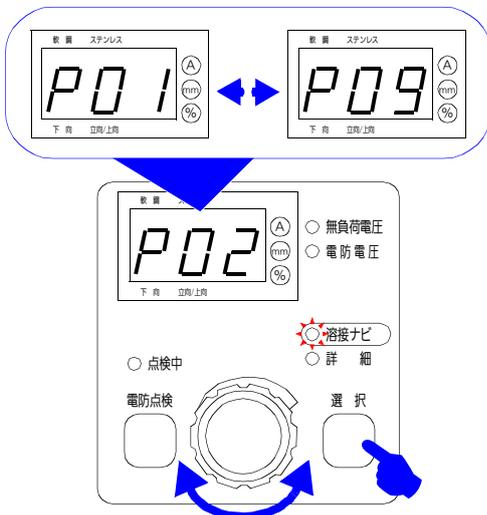
(3) ダイヤルを回してパラメーターの設定値を変更し、選択ボタンを押して確定します。
