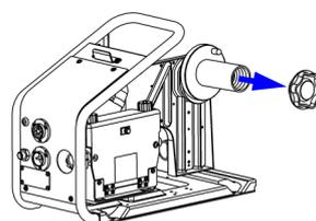
(3) ワイヤをスプール軸に取り付けます。取り付けるときは、スプール軸の回り止めピンをワイヤスプールの回り止め穴に差し込んでください。
