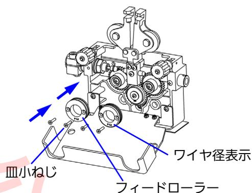
(6) 加圧アームを下げ、加圧ナットを元に戻します。
