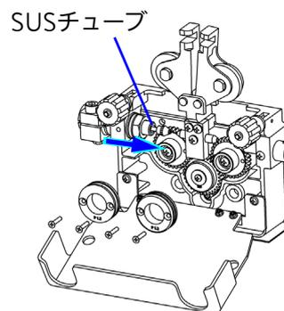
(5) フィードローラーを、使用するワイヤ径の表示が手前になるように挿入し、皿小ねじでフィードローラーを固定します。
