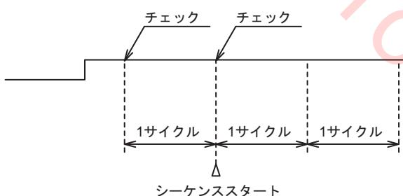
起動入力のチェックは溶接電源周波数に同期して行われます。最初に起動入力のONが確認された後に、再度チェックを行い、ONしていれば、シーケンスがスタートします。
