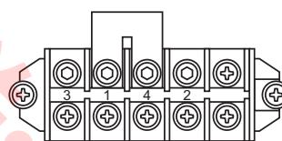
B 波形接続図 (接続板 2 枚重ね)
