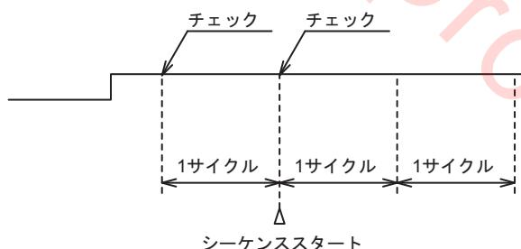
起動入力のチェックは溶接電源周波数に同期して行われます。最初に起動入力のONが確認された後に、再度チェックを行い、ONしていれば、シーケンスがスタートします。
