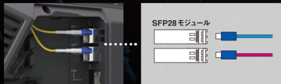
BiDi SFP28 モジュールを使用することで AK-CFA100 を介したリダンダント運用が可能。または、通常の SFP28 モジュールを使用し、外部から直接光ケーブルを接続することでカメラヘッド単体でのリダンダント運用も可能
