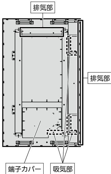
※縦置き設置は、画面に向かって本体を反時計方向に90°回転させ、本体背面端子カバー部を下側にしてください。
