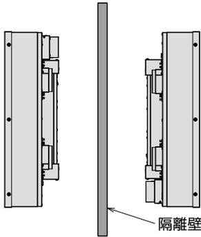
壁面埋め込み設置で、かつ機器背面に吸排気口を設けられない場合は、周囲20cm程度の隔離の確保を推奨します。その際に吸気温度が50℃を超えないようにしてください。
