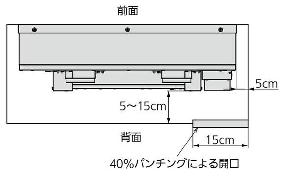
なお、機器を隣接、または背中合わせで設置する場合も同様に、排気が吸気に回り込まないように隔離壁を設ける必要があります。
