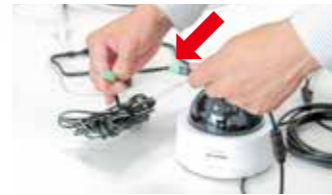
カメラとACアダプターを接続し、ACアダプターを電源コンセント※に接続します。 ※カメラの設置場所の近くに電源コンセントを用意する必要があります。
