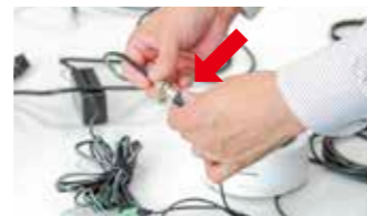
カメラの黒いコネクタに同軸ケーブルを接続します。
