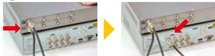
カメラ駆動ユニットの映像出力に同軸ケーブルを接続します。
