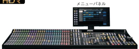
コントロールパネル (3ME/28XPTパネル、12.1型LCDメニューパネルの例)
