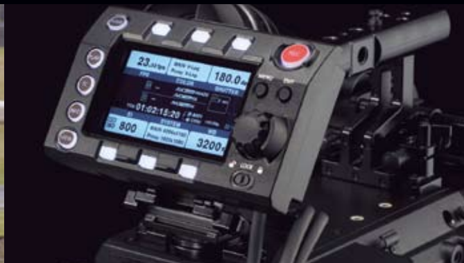
モニターを内蔵したデタッチャブル・コントロール・パネル
