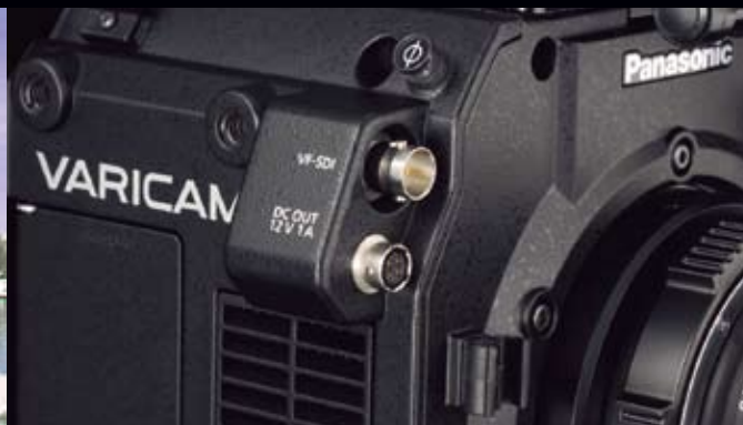
HD SDI出力とDC電源供給、2系統のEVF接続端子
