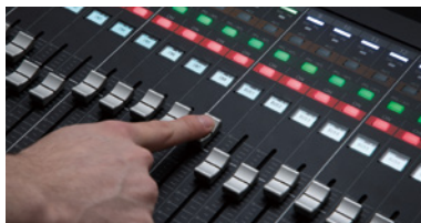
■ 追従性の高い 100 mm モータードライブフェーダー
