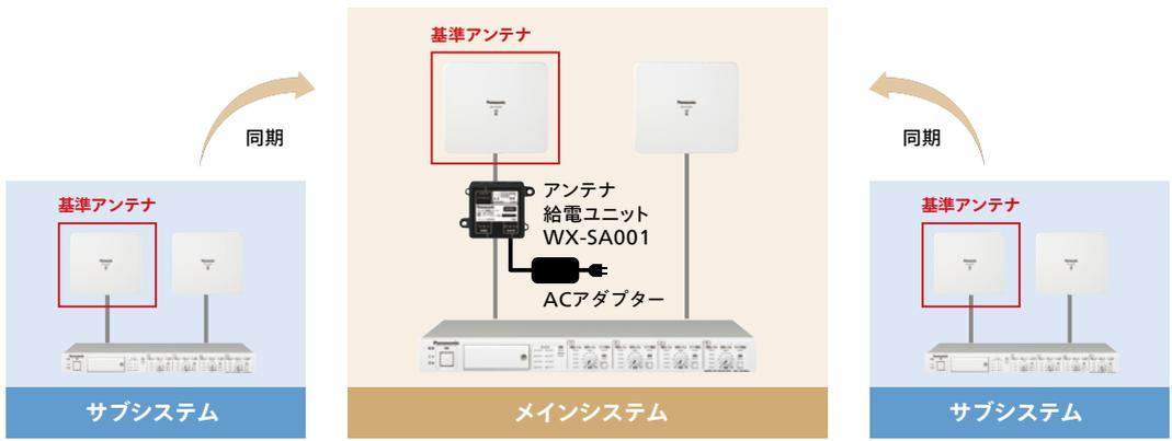
メインシステムの基準アンテナにアンテナ給電ユニットを接続します。
