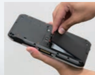
現場で容易に バッテリー交換可能 (ウォームスワップ対応)
