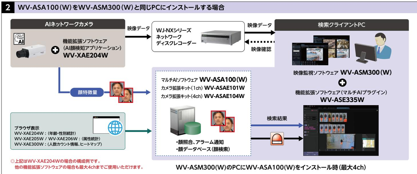
\*WV-ASM300(W)と同じPCで使用する場合、WV-ASM300(W)操作モニターは最大4画表示までご利用いただけます。操作モニター5画以上、またライブモニターを使用する場合はWV-ASM300(W)やWV-ASA100(W)が正しく動作しない可能性があります。
