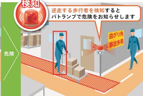
侵入検知 方向検知 の他にも、ラインクロス 滞留検知 の設定が可能です。
