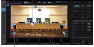
カメラ位置を示すアイコン GUI 画面上の任意の位置に配置でき、 選択中の Call Trigger に紐付けられた カメラがハイライト表示される
