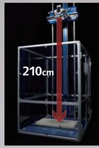
各面6方向に、コンクリートに対して落下試験を実施。
