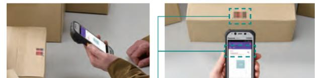
斜め配置のバーコードリーダーで、読み取り対象物、エイマー(レーザーによる赤い照準光)、端末の画面が同一の視野に入るため、より迅速で正確な作業が可能になります。
