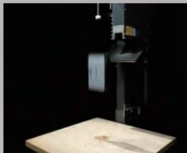
各面・辺・角の計26方向に、合板に対して120cm以上の高さから落下試験を実施。
