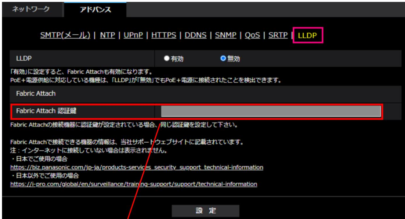
Fabric Attachの接続されている機器に認証鍵が設定されている場合は、同じ認証鍵を設定下さい
